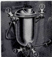
Fig. 14. Installation filtre Lavalette.
